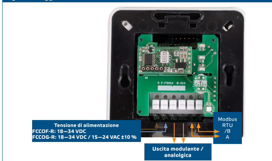
Fig. 1 Cablaggio e connessioni
