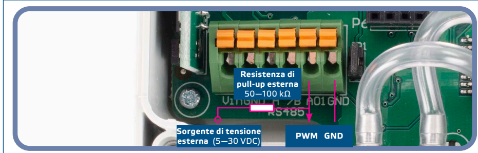
Fig.6 Collegamento PWM (Collettore aperto)
