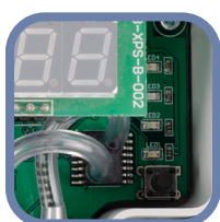
Fig. 8 Interruttore touch e indicazione di calibrazione del sensore e registro Modbus azzeramento
