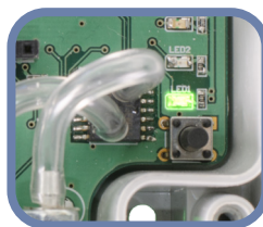
Fig. 16 Indicazione di comunicazione Power / Modbus
