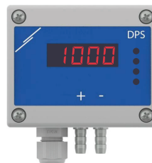
Fig. 9 Visualizzazione della pressione differenziale
