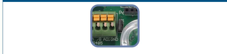
Fig. 5 Ponticello della resistenza pull-up collegato
