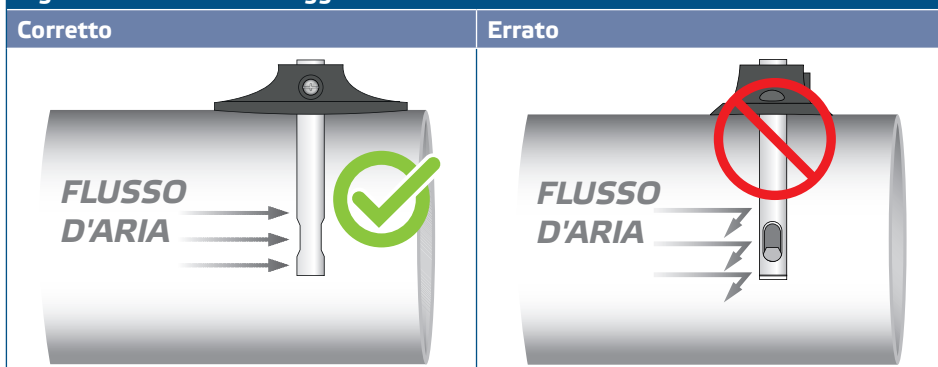
Fig. 2 Posizione di montaggio
