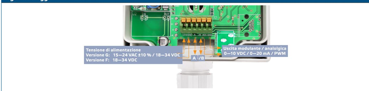
3. Chiudere il contenitore e fissare il coperchio. Stringere il pressacavo per mantenere il grado di protezione IP del contenitore.
