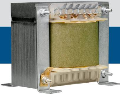
La serie W-FTC è costituita da Autotrasformatori per il montaggio in quadri elettrici. Tipicamente, vengono utilizzati per regolare la velocità di ventilatori con motori controllabili in tensione (1-ph 230 VCA / 50–60 Hz). Quando si seleziona un autotrasformatore, è importante tenere conto della capacità massima di corrente. La corrente massima nominale è disponibile su ogni uscita. Tutti gli avvolgimenti utilizzano filo dello stesso diametro.
