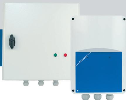
La serie STVS1 di regolatori di velocità del ventilatore ad autotrasformatore regolano la velocità di rotazione dei motori monofase controllabili in cinque fasi variando la tensione di uscita in base a un segnale di ingresso analogico 0–10 VDC. Sono dotati di autotrasformatore(i) e dispongono di monitoraggio TK per la protezione termica del motore. I regolatori fino a 7,5 A sono disponibili in involucro di plastica, mentre i modelli sopra 7,5 A sono disponibili in un involucro di metallo.
