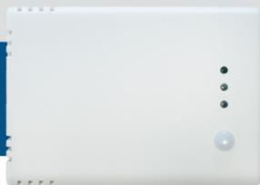
Le serie RWTHM-2 sono trasmettitori interni combinati che misurano la temperatura interna, l'umidità relativa e la luce ambientale. Sulla base di queste misurazioni, è possibile calcolare il punto di rugiada. Sono dotati di un secondo sensore di temperatura situato su una piastra di alluminio sul retro del contenitore del dispositivo per misurare la temperatura della superficie su cui è montato. Le serie sono dotate di Power over Modbus e tutti i parametri sono accessibili tramite Modbus RTU.
