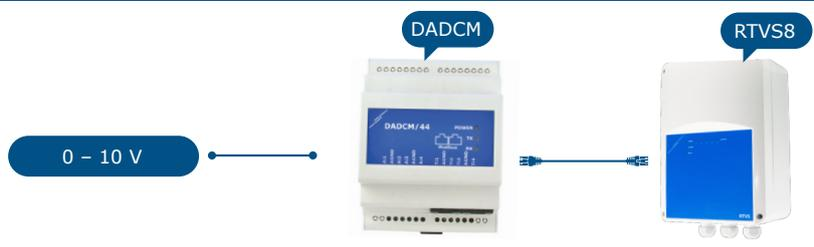
**Esempio di applicazione 4** Automatic mode - control via analogue signal
