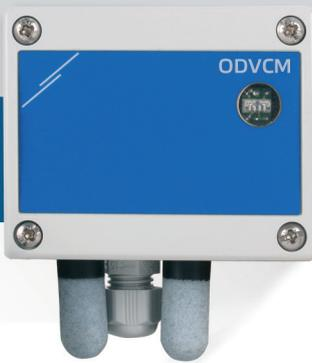
ODVCM-R sono trasmettitori multifunzionali per ambienti difficili che misurano temperatura, umidità relativa, TVOC e luce ambientale. La concentrazione di TVOC è un indicatore accurato per la qualità dell'aria interna. In base alle misurazioni della temperatura e dell'umidità relativa, è possibile calcolare la temperatura del punto di rugiada. Power over Modbus in dotazione e tutti i parametri sono accessibili tramite Modbus RTU.
