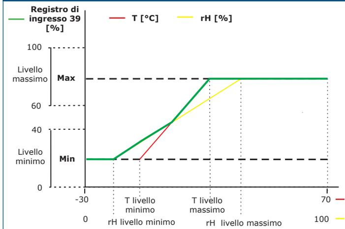
**Nota:** L'uscita cambia automaticamente a seconda del più alto dei valori T e rH, cioè il più alto dei due valori di uscita controlla l'uscita. Vedi la linea verde nel diagramma operativo sopra. È possibile disattivare uno o più sensori. Per esempio, è inoltre possibile controllare l'uscita in base ai soli valori di umidità relativa misurati. 1]
