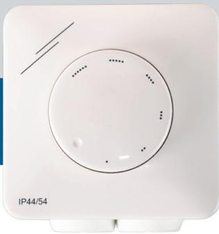
I controller MT forniscono il controllo manuale della velocità di rotazione dei motori controllabili in tensione (230 VAC / 50 Hz) variando la tensione fornita attraverso il controllo dell'angolo di fase. Sono adatti sia per il montaggio a incasso che su superficie. È possibile collegare più motori al controller purché non venga superato il limite di corrente. Tutti i modelli hanno un'uscita extra (non regolata) da 230 VAC.
