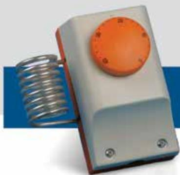
I termostati ambiente industriali IMRT sono ideali per applicazioni in ambienti difficili (umidi). Sono termostati meccanici unipolari adatti per la commutazione di ventilatori, impianti di riscaldamento elettrici o altri regolatori Sentera in climatologia industriale e agricola (magazzini, serre, stalle ecc.). Queste unità sono dotate di un bulbo riempito di gas e di una spirale esterna ottimizzata che garantiscono un rilevamento della temperatura accurato e affidabile.
