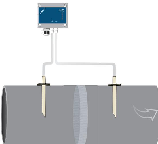
**Applicazione 2:** Misurazione del volume d'aria di mandata \ [m<sup>3</sup> / h] o della velocità del flusso d'aria \ [m / s] utilizzando PSET-PT
