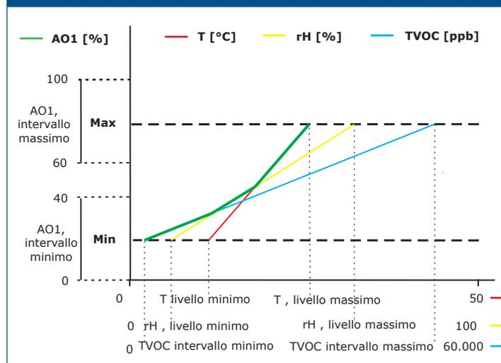
**Nota:** \*Le misurazioni TVOC restituiranno 0 ppb durante il tempo di riscaldamento. L'uscita cambia automaticamente in base al più alto dei valori T, rH o TVOC, cioè il più alto dei tre valori di uscita controlla l'uscita. Vedi la linea verde nel diagramma operativo sopra. È possibile disattivare uno o più sensori. Per esempio, è anche possibile controllare l'uscita solo in base ai valori TVOC misurati.
