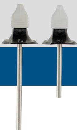
La serie DTS-M sono sensori di temperatura digitali alimentati via Modbus a 24 VDC tramite un connettore RJ45. Sono progettati per essere utilizzati nei condotti d'aria e sono compatibili con vari sistemi di controllo della temperatura. L'elemento sensore è posto in un tubo di acciaio inossidabile, che semplifica la pulizia del sistema dei canali. Sono disponibili due versioni del prodotto con diverse lunghezze del tubo: 85 e 165 mm.
