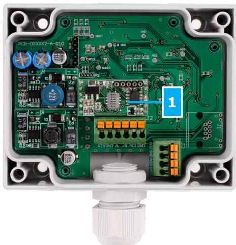
1 - Elemento sensore CO / NO<sub>2</sub> sostituibile Sostituibile in caso di funzionamento difettoso
