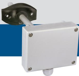
DSCOX-R sono trasmettitori da canale multifunzionali che misurano i livelli di temperatura, umidità relativa, monossido di carbonio e biossido di azoto nei condotti. In base alle misurazioni della temperatura e dell'umidità relativa, viene calcolata la temperatura del punto di rugiada. Sono dotati di 3 uscite analogiche / modulanti: una per la temperatura, una per l'umidità relativa e una per CO / NO<sub>2</sub>. Tutti i parametri e le misure sono accessibili tramite Modbus RTU.
