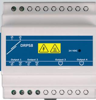
DRPS8-24/40 sono moduli di alimentazione montati su guida DIN 24 VDC / 40 W con due connettori RJ45 e morsettiere per il collegamento della tensione di uscita. Sono compatibili con sistema di comunicazione Power over Modbus e hanno un'ampia gamma di tensioni di alimentazione.
