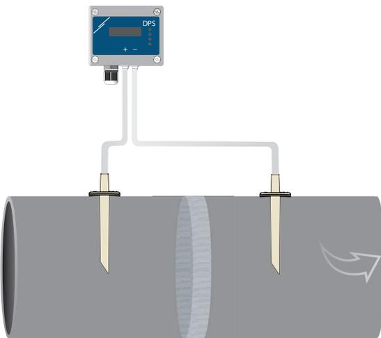
**Applicazione 2:** Misurazione del flusso volumetrico fornito  $\backslash$  [m<sup>3</sup>/h] o della velocità dell'aria  $\backslash$  [m/s] utilizzando il set di collegamento del tubo di Pitot PSET-PT
