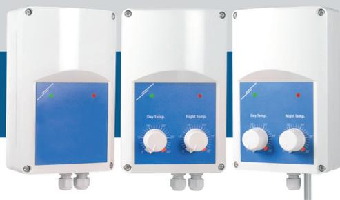
Le serie AH2X1-6 sono regolatori di riscaldamento elettrico per riscaldamento elettrico monofase o bifase. Utilizzano il controllo proporzionale al tempo: il rapporto tra gli orari di apertura e di chiusura al fine di soddisfare i requisiti di riscaldamento. La corrente è ottenuta da un triac a commutazione, che riduce al minimo l'usura, mentre una maggiore precisione del controllo riduce i costi energetici.
