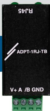
ADPT-1RJ-TB è un adattatore per convertire Power over Modbus (PoM) da RJ45 a una normale morsettiera e viceversa. PoM è lo standard Sentera per la distribuzione di Modbus RTU e alimentazione tramite un singolo connettore RJ45. L'adattatore ADPT-1RJ-TB facilita l'interconnessione di dispositivi Sentera con PoM a dispositivi con normali morsettiere.
