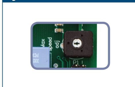
**Fig. 6 Trimmer de vitesse min.**
