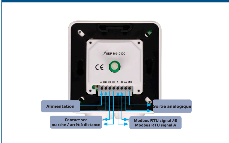
Fig. 1 Câblage et raccordements
