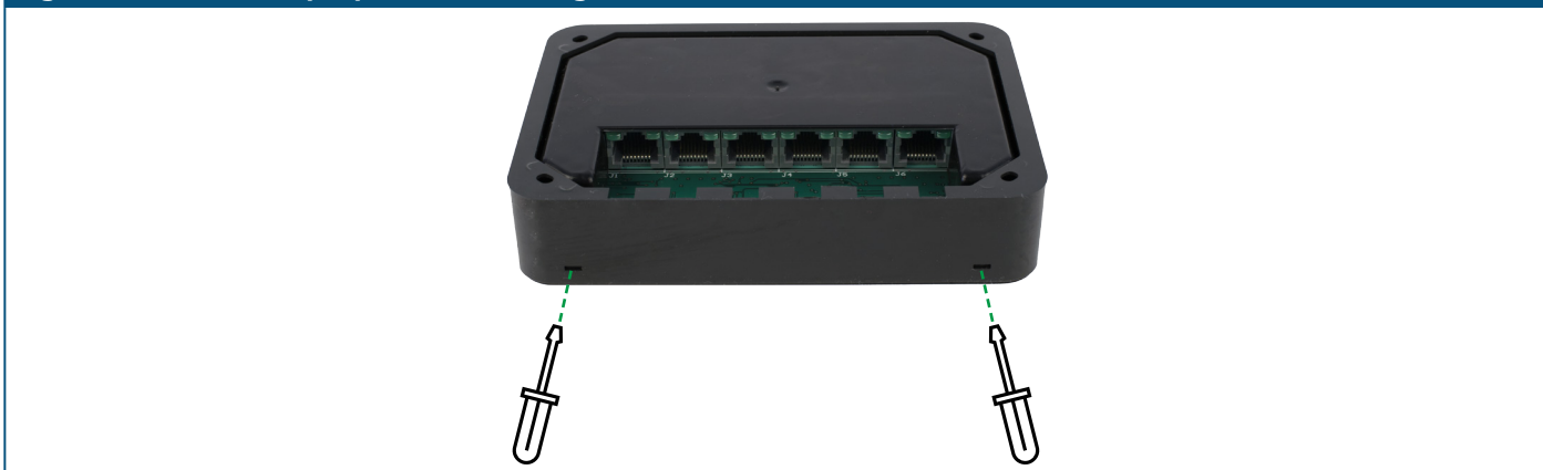
Fig. 1 Enlèvement des plaques de verrouillage
