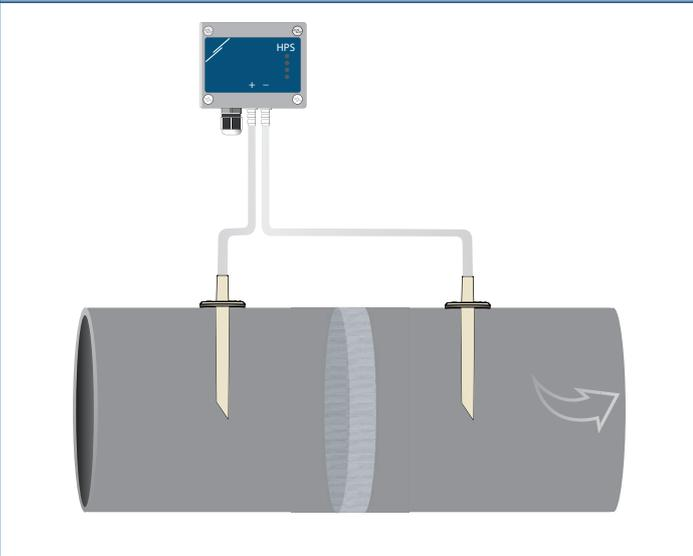
**Exemple d'application 2: Mesure du volume d'air fourni \ [m<sup>3</sup>/h] ou de la vitesse du flux d'air [m/s] à l'aide du PSET-PT**
