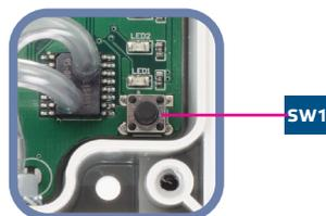
**Fig. 7 Indication d'étalonnage**
