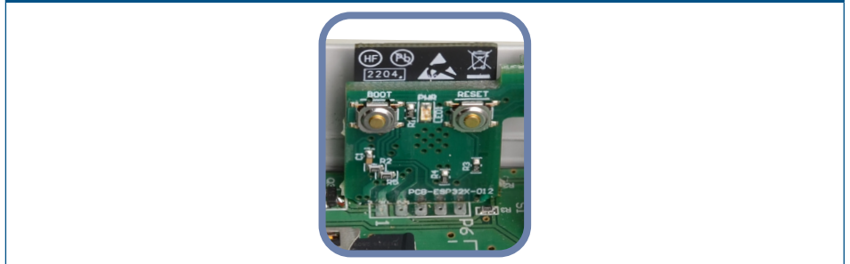
Fig. 8 Bouton poussoir de réinitialisation pour le Wi-Fi.
