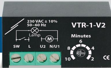
Le VTR-1-V2 est une minuterie électronique, commandé par triac pour les ventilateurs ventilant les petits espaces tels que les toilettes et les salles de bains. Le ventilateur est activé 1,5 s après que la lumière est allumée. Lorsque la lumière est éteinte, le ventilateur est désactivé après un délai réglable entre 2 et 10 minutes.
