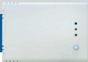
Les séries RWTHM-2 sont des transmetteurs d'ambiance multifonctionnels qui mesurent la température intérieure, l'humidité relative et la lumière ambiante. Sur la base de ces mesures, le point de rosée peut être calculé. Ils sont équipés d'un deuxième capteur de température situé sur une plaque d'aluminium sur l'arrière du boîtier afin de mesurer la température de la surface sur laquelle il est monté. Les séries sont alimentées par Modbus et tous les paramètres sont accessibles via Modbus RTU.
