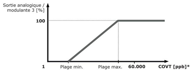
\* La mesure COVT retournera 0 ppb pendant le temps de préchauffage.
