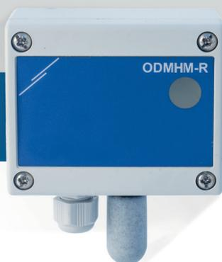
Les ODMHH-R sont des transmetteurs multifonctionnels pour l'extérieur qui mesurent la température, l'humidité relative, le niveau de CO<sub>2</sub> et la lumière. Sur la base de ces mesures, la température du point de rosée peut être calculée. Ils sont alimentés par Modbus et tous les paramètres, ainsi que la sortie, sont accessibles via Modbus RTU.
