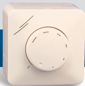
Le potentiomètre MTV-1/010-NA est conçu pour commander l'équipement qui a besoin d'un signal de commande 0–10 VDC. Le potentiomètre nécessite une alimentation de 230 VAC et il fournit un signal de sortie en continu variable 0–10 VDC. Ils sont adaptés pour le montage encastré (IP44) ainsi que pour le montage en saillie (IP54).
