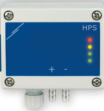
Les séries HPS-M -2 sont des transmetteurs de pression différentielle équipés d'un transducteur de pression entièrement numérique conçu pour une large gamme d'applications. La lecture de la vitesse d'écoulement de l'air est disponible en connectant un ensemble de connexion de tube de Pitot externe. Ils sont alimentés par Modbus et les paramètres sont accessibles via Modbus RTU (logiciel 3SModbus ou Sensistant).
