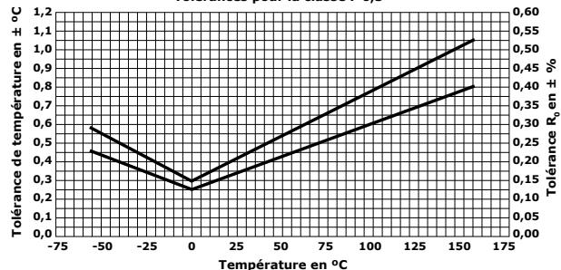
Le schéma ci-dessus montre les tolérances de température et de résistance des RTD à différentes températures.
