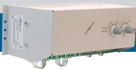
Les régulateurs proportionnels de chauffage EH3C sont conçus pour contrôler la température de l'air dans les systèmes de chauffage triphasés (400 V) en offrant un contrôle continu et ajustable de la charge. Le régulateur ajuste le rapport entre le temps de marche et le temps d'arrêt pour produire la puissance de chauffage requise.
