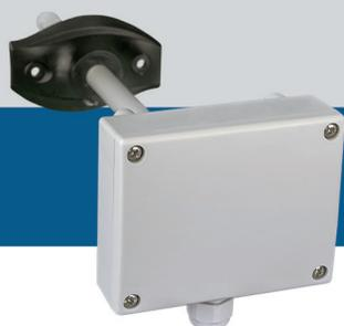
Les séries DSTHX-3 sont des transmetteurs de gaine qui mesurent la température et l'humidité relative. Ils disposent d'une large plage d'alimentation basse tension et de trois sorties analogiques / modulantes. Tous les paramètres sont accessibles via Modbus RTU.
