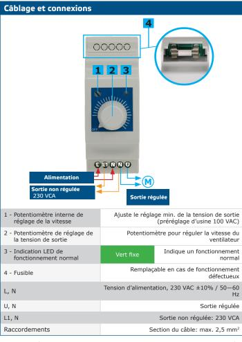
**Note:** Pour désactiver la position OFF, connectez la tension d'alimentation 230 VAC à la sortie non régulée (L1). Dans ce cas, ne branchez pas l'alimentation à L. Réglez la tension minimale du moteur en fonction des exigences de l'application et des
