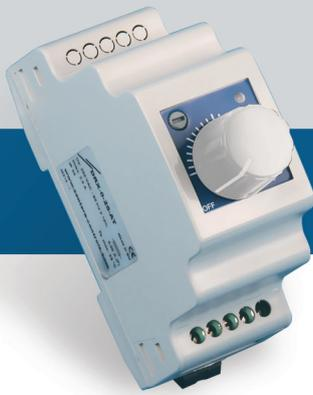
Les séries DRX et DRY sont des variateurs de vitesse pour ventilateurs AC avec moteur monophasé contrôlable en tension. Ils fournissent une régulation de sortie de haut à bas (DRX) ou bas à haut (DRY) et un réglage de la tension de sortie minimale. Le boîtier du variateur est conçu pour être monté sur un rail DIN standard de 35 mm.
