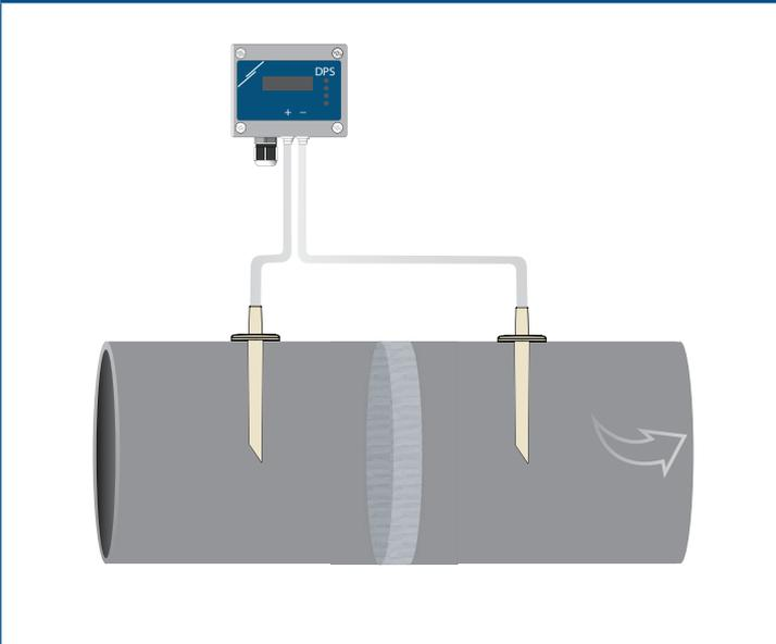
**Exemple d'application 2:** Mesure du débit volumique fourni  $[\text{m}^3/\text{h}]$  ou de la vitesse de l'air  $[\text{m}/\text{s}]$  à l'aide du kit de connexion de tube de Pitot PSET-PT
