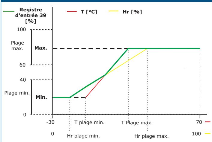
**Note:** La sortie change automatiquement en fonction de la plus élevée des valeurs T et Hr, c'est-à-dire que la plus élevée des deux valeurs contrôle la sortie. Voir la ligne verte dans le diagramme opérationnel ci-dessus. Un ou plusieurs capteurs peuvent être désactivés. Par exemple: il est également possible de contrôler la sortie uniquement sur la base des valeurs de température mesurées.
