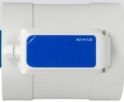
Les séries ACT-H sont des registres motorisés circulaires pour réguler le débit d'air dans les systèmes de conduits. La position du clapet du registre peut être réglée via une entrée analogique / modulante ou via une communication Modbus RTU. La tension d'alimentation est de 24 VDC. Tous les paramètres sont accessibles via la communication Modbus RTU.
