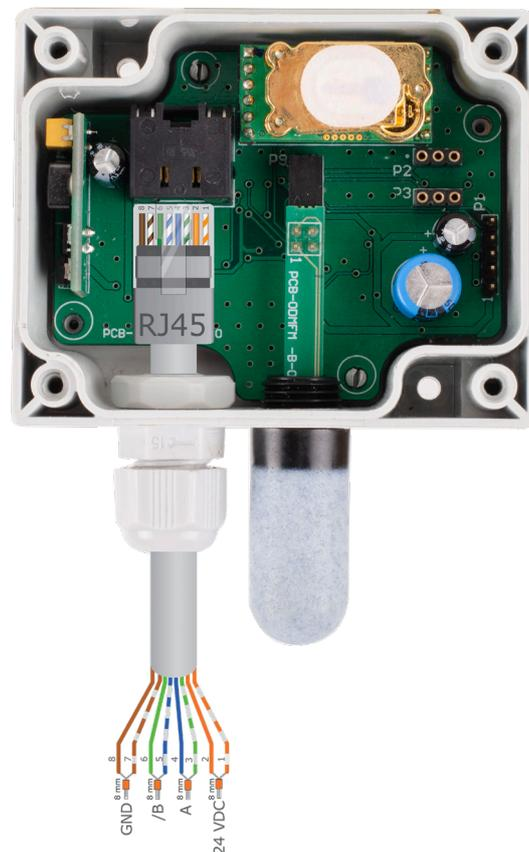
4. Cierre el panel fijándolo con los tornillos. Apriete los prensaestopas para garantizar el grado de protección IP del dispositivo.
