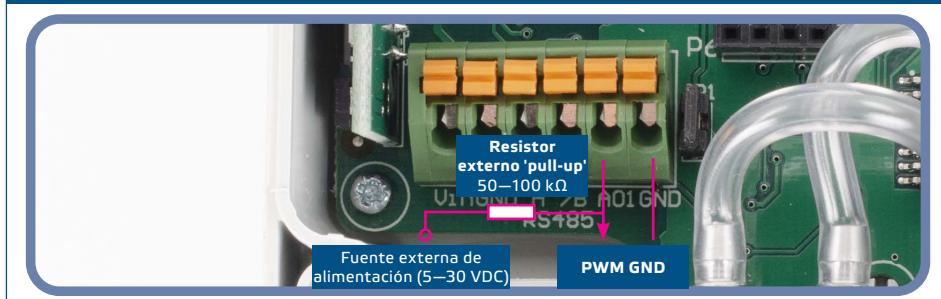
Fig. 6 Conexión PWM (Colector abierto)
