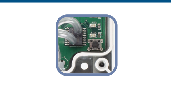
Fig. 8 Botón pulsador para calibración del sensor y reinicio de los registros Modbus.
