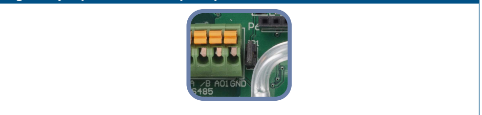
Fig. 5 El 'jumper' del resistor 'pull-up' está conectado
