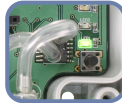
Fig. 7 Indicación de alimentación / comunicación Modbus
