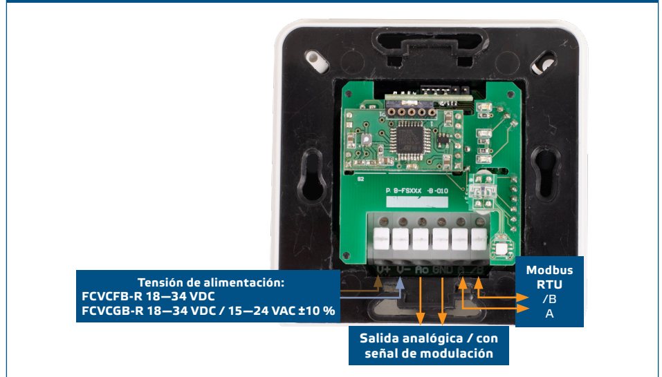
Fig. 1 Cableado y conexiones
