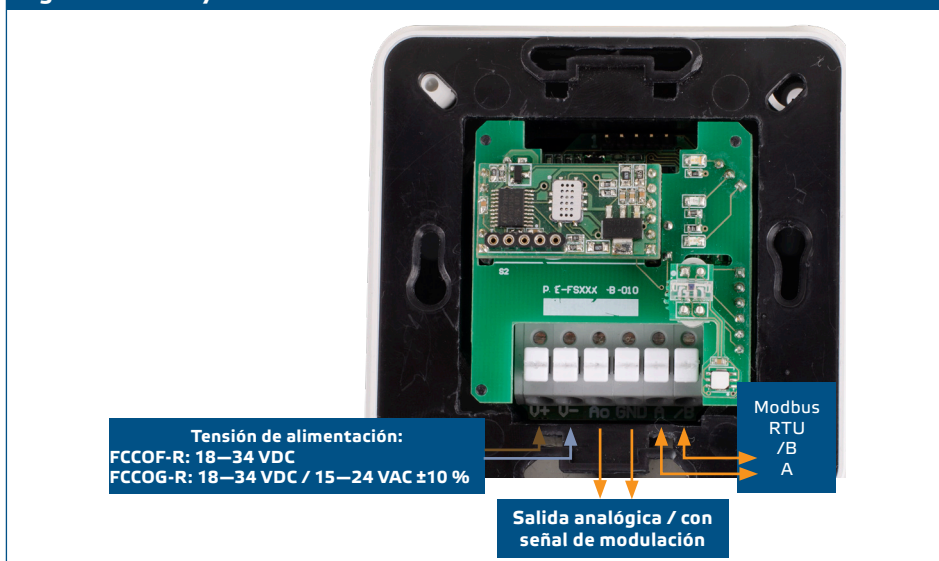
Fig. 1 Cableado y conexiones
