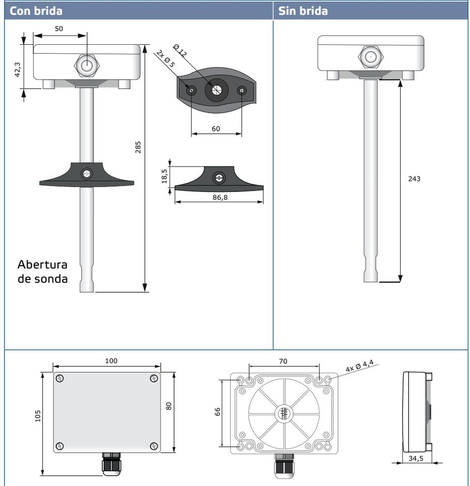
**Fig. 2 Posición de montaje**
