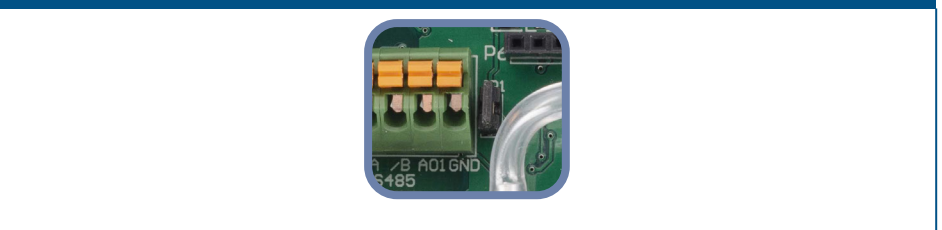
Fig. 5 El 'jumper' del resistor 'pull-up' está conectado
