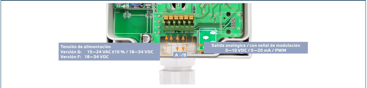
3. Cierre el panel frontal y fíjelo con los tornillos. Apriete los prensaestopas para garantizar el grado de protección IP del dispositivo.
